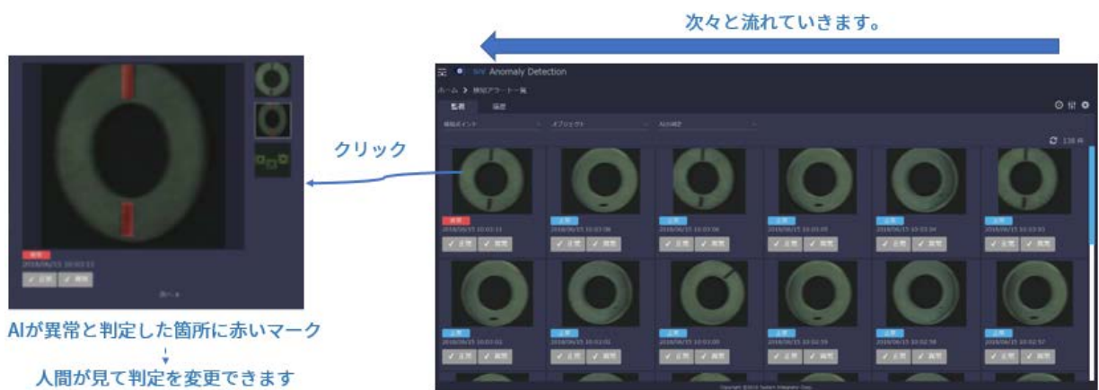
図 4：ワッシャーの異常検知（リアルタイムモニタリング画面）
